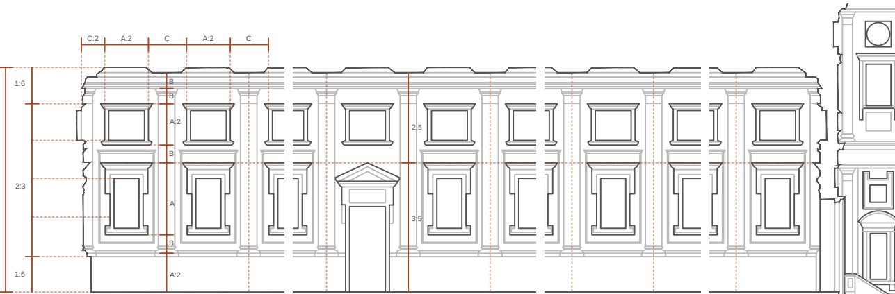
Figura 12 - Métricas e proporções utilizadas por Michelangelo no vestibulo e sala de leitura(Alçado vestibulo, planta vestibulo e alçado da sala de leitura).
