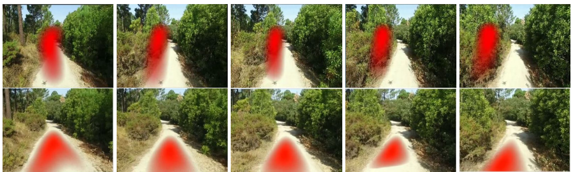
FIGURA 35: Imagens do resultado obtido pelo detetor original numa situação de falha, no teste realizado à sequência de imagens completa do Vídeo 12. Na primeira linha é ilustrado o resultado obtido pelo detetor original, na segunda linha é ilustrado o resultado obtido pelo sistema proposto.
