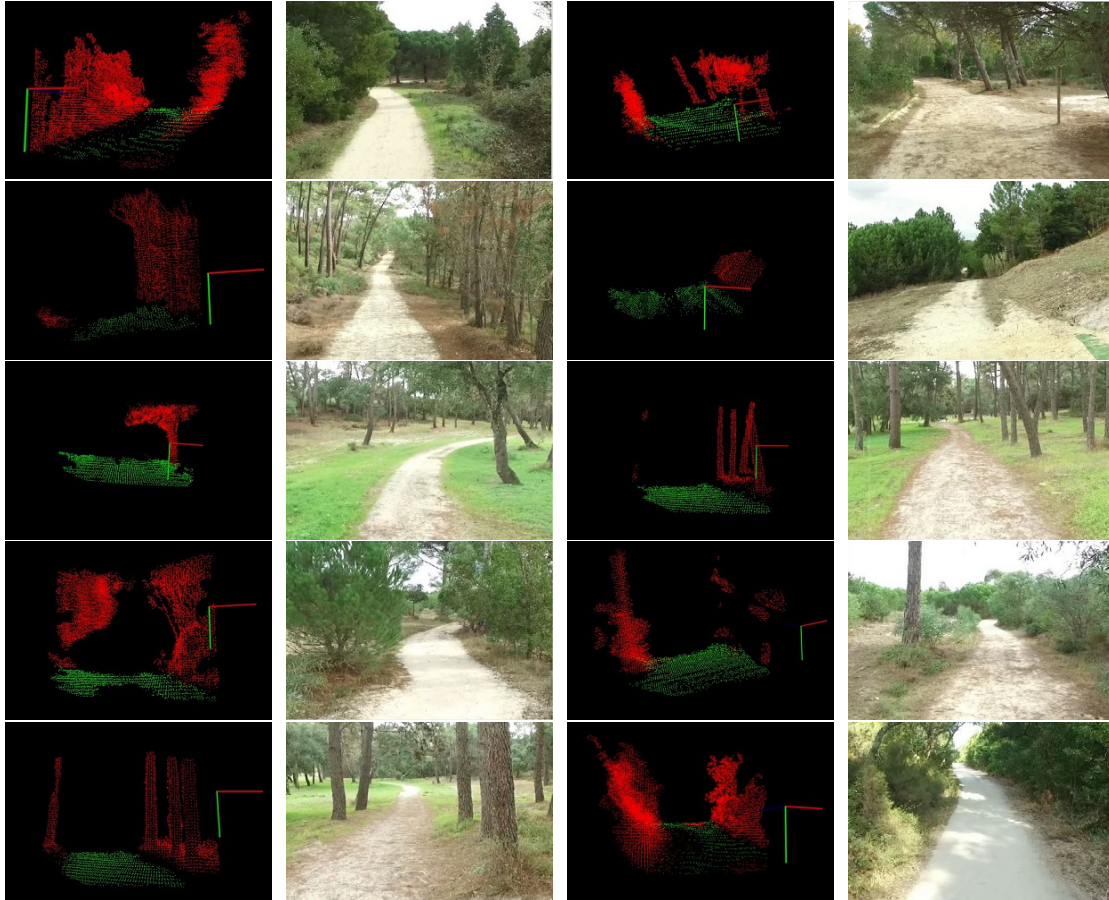
FIGURA 31: Sub-conjunto de resultados típicos obtidos com o conjunto de dados de teste, que demonstra a reconstrução tridimensional do ambiente descrito em frente do robô ( \approx 8\text{m} ). As imagens com a reconstrução tridimensional, primeira e terceira colunas, ilustram as nuvens de pontos obtidas onde, os pontos a vermelho descrevem os obstáculos e os pontos a verde descrevem o plano do chão.
