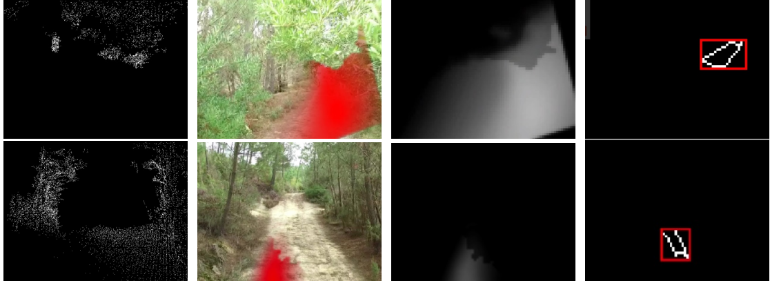
FIGURA 38: Sub-conjunto de resultados típicos que demonstram o funcionamento do módulo Validador. A primeira linha ilustra a identificação de uma falha causada pela calculo do fluxo ótico. A segunda linha ilustra a identificação de uma falha causada por um errado sinalizar de obstáculos na região onde se encontra o trilho. A primeira coluna ilustra a projeção da informação da presença de obstáculos para o plano da câmara, a segunda coluna ilustra o resultado do detetor de trilhos, a terceira coluna ilustra a atividade do campo neuronal, NF , e a quarta coluna ilustra o resultado obtido pelo módulo Validador.
