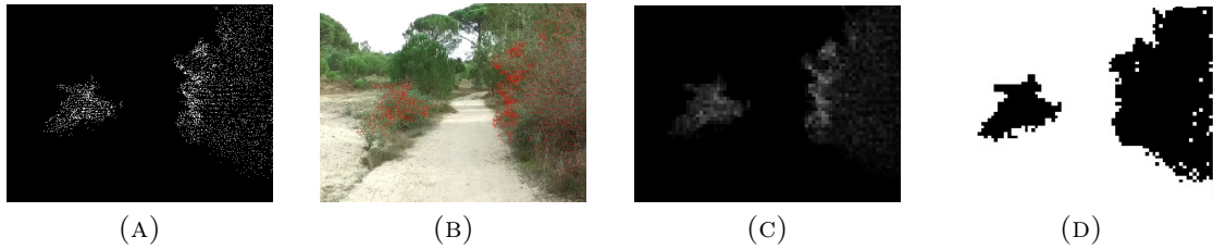
FIGURA 22: (A) Projeção dos pontos 3D no plano da câmara; (B) Pontos 3D, a vermelho, projetados na imagem original; (C) Máscara que indica as regiões caracterizadas como obstáculo em escala de cinzentos onde as regiões mais claras indicam uma maior concentração de pontos 3D; (D) Máscara binária que indica as regiões caracterizadas como obstáculo a preto.
