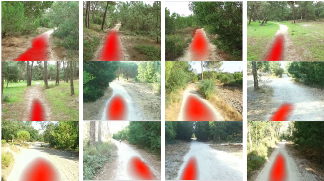
FIGURA 37: Resultado obtido na identificação da região hipótese do trilho por vídeo. Da esquerda para a direita e de cima para baixo do Vídeo 1 até ao Vídeo 12.
