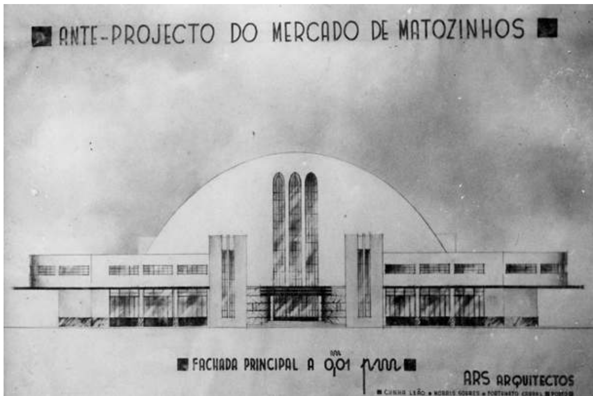
Figura 171: “Ars Architectos”: Ante-projecto para Mercado Municipal de Matosinhos, 1936. Alçado principal. A importância da abóbada na solução é facilmente perceptível.
