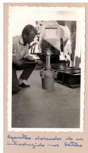
Aparelho dosadores do ar introduzido nos betões Figura 24 Fotografia cedida pelo engenheiro Pereira dos Santos.
