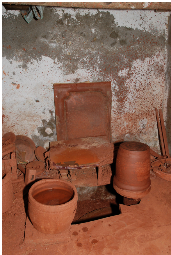
Ilustração 15- Roda com louceiro do lado esquerdo, prato e alpiota do lado direito
