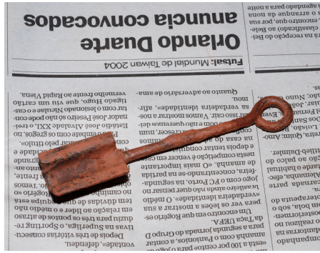
Ilustração 24- Utensílio de trabalho utilizado na realização das reentrâncias dos cinzeiros.
