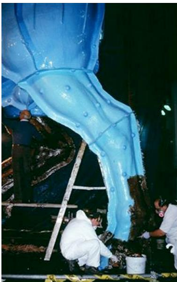
Molde de borracha azul e aplicação de resina de fibra de vidro no molde principal; secções deste molde sobre o molde de borracha; molde de areia
