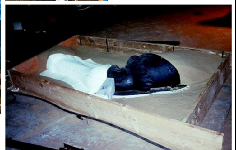
Molde de borracha azul e aplicação de resina de fibra de vidro no molde principal; secções deste molde sobre o molde de borracha; molde de areia
