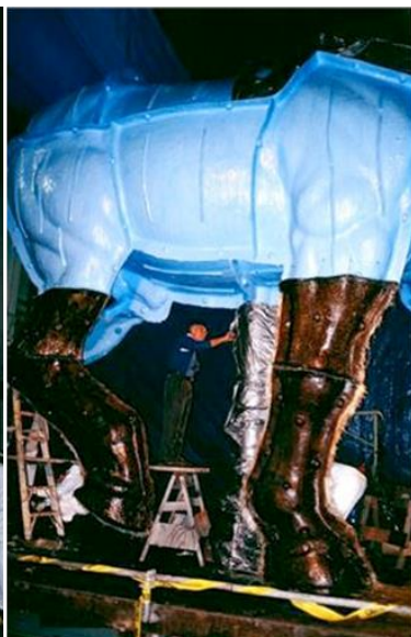
Molde de borracha azul e aplicação de resina de fibra de vidro no molde principal; secções deste molde sobre o molde de borracha; molde de areia
