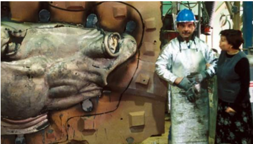
Secção da cabeça após a fundição em bruto; fundição em bronze do cavalo a partir de 1998
