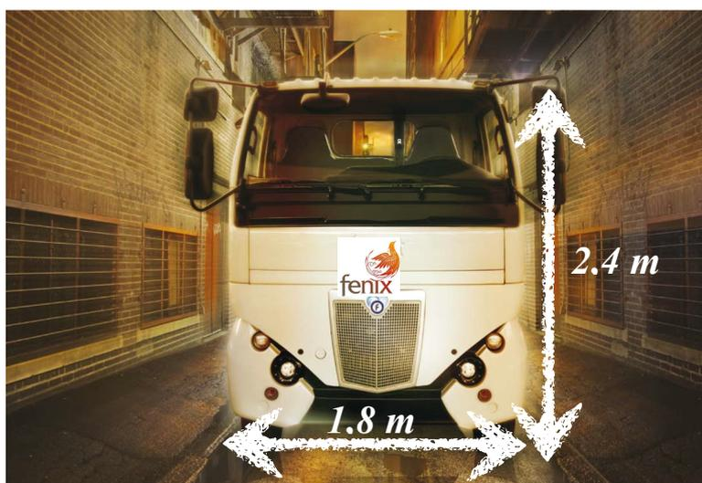
**Figura 2** - Viatura pesada especialmente dimensionada para lidar com as restrições de acessos dos bairros históricos.
