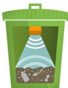
Figura 19: Funcionamento do sistema por sensor volumétrico
