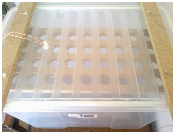
Figura 4.8 | Provete em ensaio na caixa 4. Trave em madeira para suspensão do provete e abertura na tampa da caixa para entrada dos sensores.
