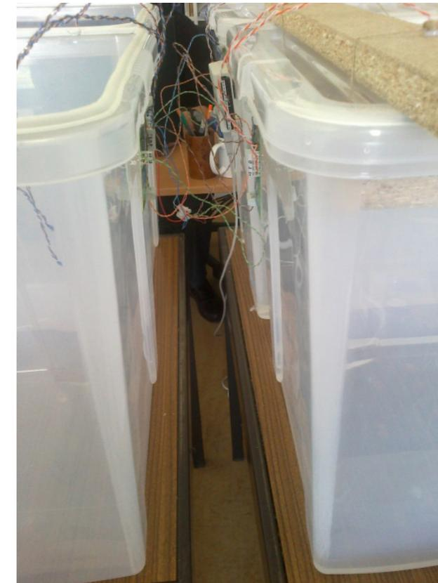
Figura 4.6 | Ligações entre as 4 caixas. Placas dos sensores fixados nas laterais das caixas de forma mais ou menos equidistante.
