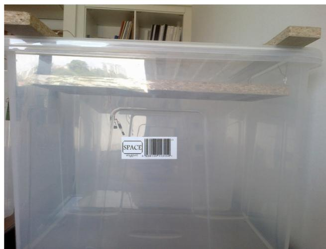
Figura 4.7 | Provete em ensaio na caixa 4. Suspensão do provete e sensores no interior da caixa a atravessar os orifícios do provete.
