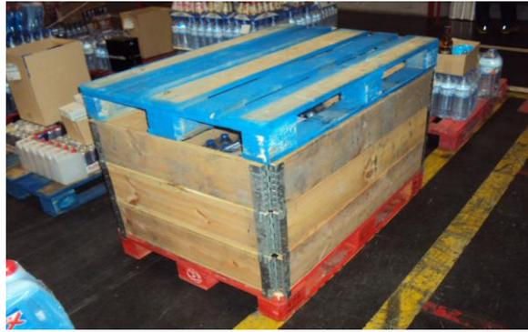
Figura 19 - Preparação de uma palete com utilização de colares
