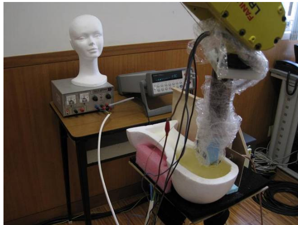
Figura C.1 Medição de SAR com recurso ao braço robótico
