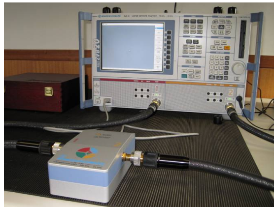
Figura 13. Analisador vectorial de circuitos (VNA). Modelo ZVB20 da Rohde & Schwarz. Também se vê na imagem uma caixa que é um kit para calibração automática dos portos do VNA.
