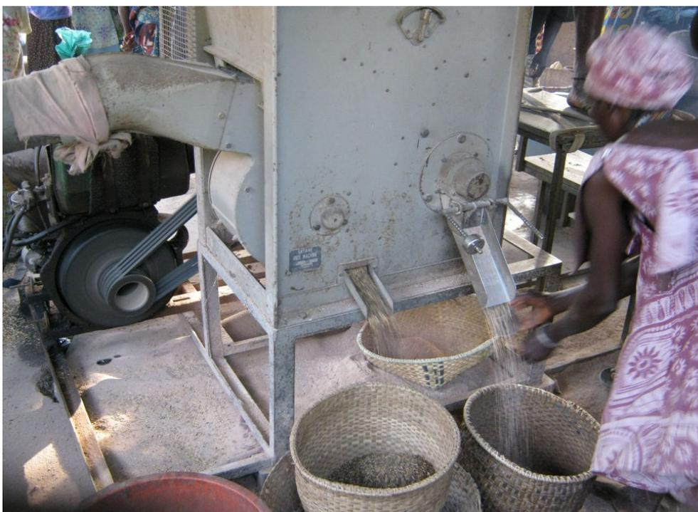
**Figura 2:** Mulher utilizando a máquina descascadora de arroz<sup>39</sup>
