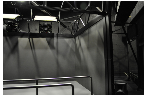
Figura 17 - Dois conjuntos de dois projetores que asseguram a imagem das projeções frontais em ambos os planos (Agosto 2013)
