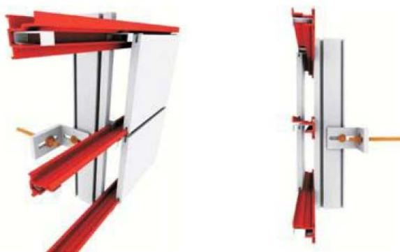
Figura 21 – Ancoragem linear (fonte: SOUSA, 2010,47)
