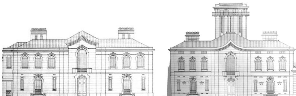
Figura 166 - Hospital Termal das Caldas da Rainha, Caldas da Rainha, 1928 – Alçados principais das duas versões do projecto de remodelação – Excerto de desenho a tinta-da-china e lápis sobre papel vegetal, com dimensões aproximadas de 1,60x0,30m. [MDCivil – IST]
