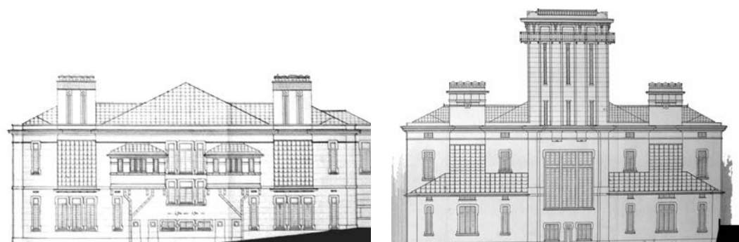
Figura 170 - Hospital Termal das Caldas da Rainha, Caldas da Rainha, 1928 – Alçados posteriores das duas versões do projecto de remodelação – Excerto de desenho a tinta-da-china e lápis sobre papel vegetal, com dimensões aproximadas de 1,60x0,30m.
