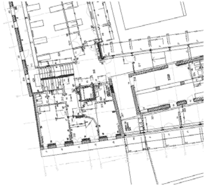
Fig. 2 – Desenho com estrutura de layers com toda a informação visível para determinado piso para a esc.1/50
