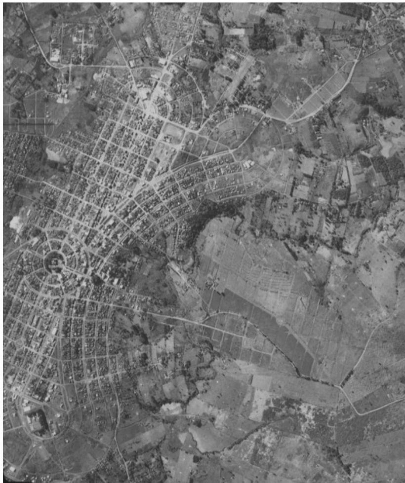
Figura 1. Aerofoto de Ivaiporã, 1980: centralidade, simetria e adaptação ao relevo. Projeto do engenheiro civil Yaroslau Sessak, 1953. Fonte: ITCG.
