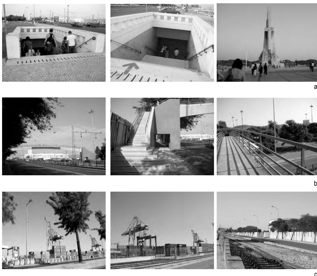
Figura 4. Formas de ultrapassagem pedonal da dupla barreira rodo/ferroviária · (Fotografias da autora, 2008-10) (a) a uma cota inferior à da dupla barreira, em túnel; (b) a uma cota superior, em viaduto; (c) à mesma cota (de nível).
