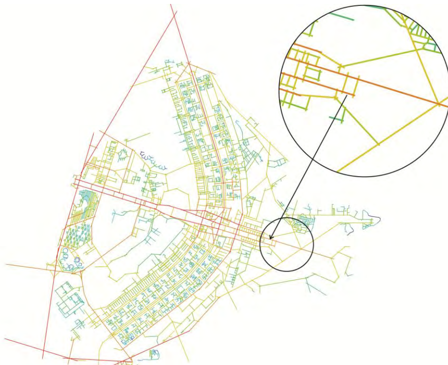
Figura 12. Mapa axial do Plano Piloto de Brasília: as vias que levam à Praça dos Três Poderes (N1 e S1) fazem parte do núcleo de integração. Crédito do mapa axial: Grupo DIMPU/UnB.
