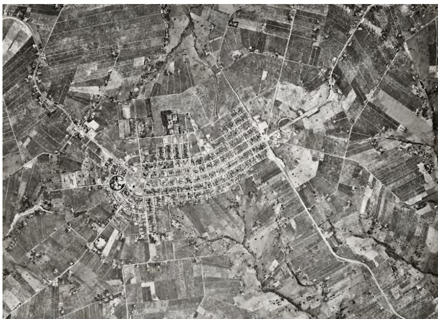
Figura 8. Aerofoto de Pérola, 1980: simetria e inflexão da forma devido à nascente próxima, ponto focal e vias radiais Avenida central se abrindo em vias radiais. Projeto do engenheiro civil Arthur Bruno Junges, 1953. Fonte: ITCG.
