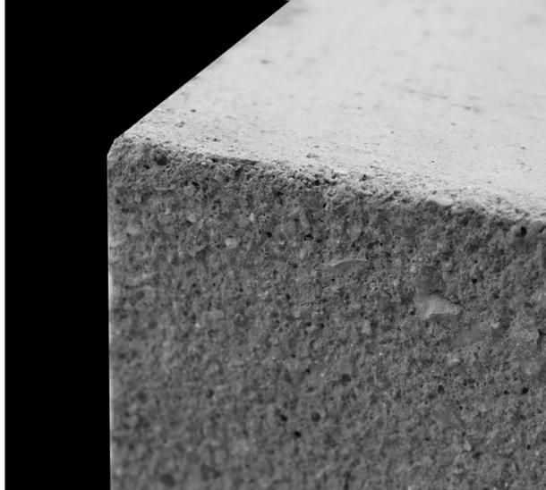
Figura 64. Maquete em cimento da marca Secil misturado com inertes de rocha local
