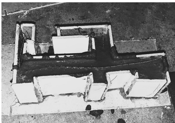
Figura 57 Fotografia da cofragem das paredes interiores do projeto durante a elaboração da maquete de cimento à escala 1:50.
