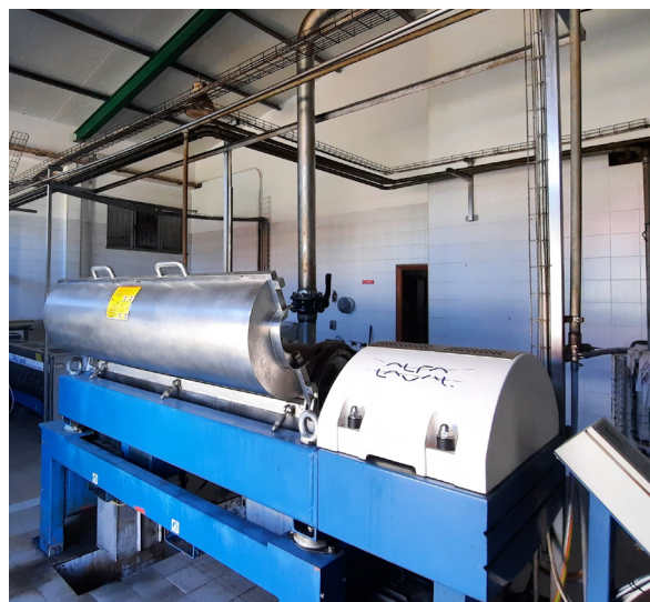
Imagem 51 - Modelo de centrifugação horizontal atual no lagar de azeite cooperativo em Sendim de Miranda
