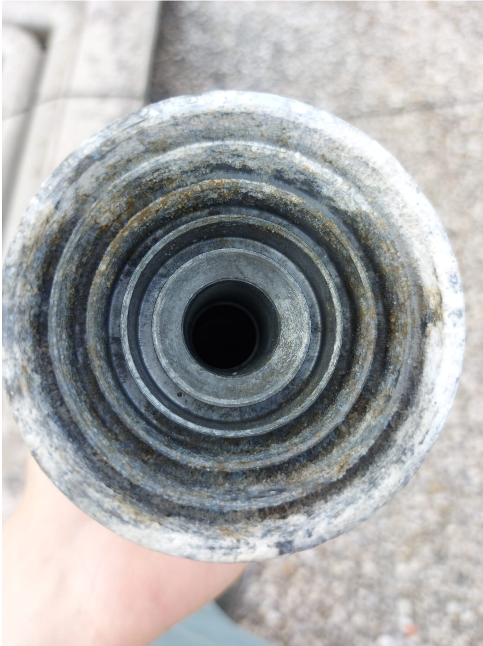
FIGURA 33. LNB com desgaste provocado por efeitos meteorológicos
