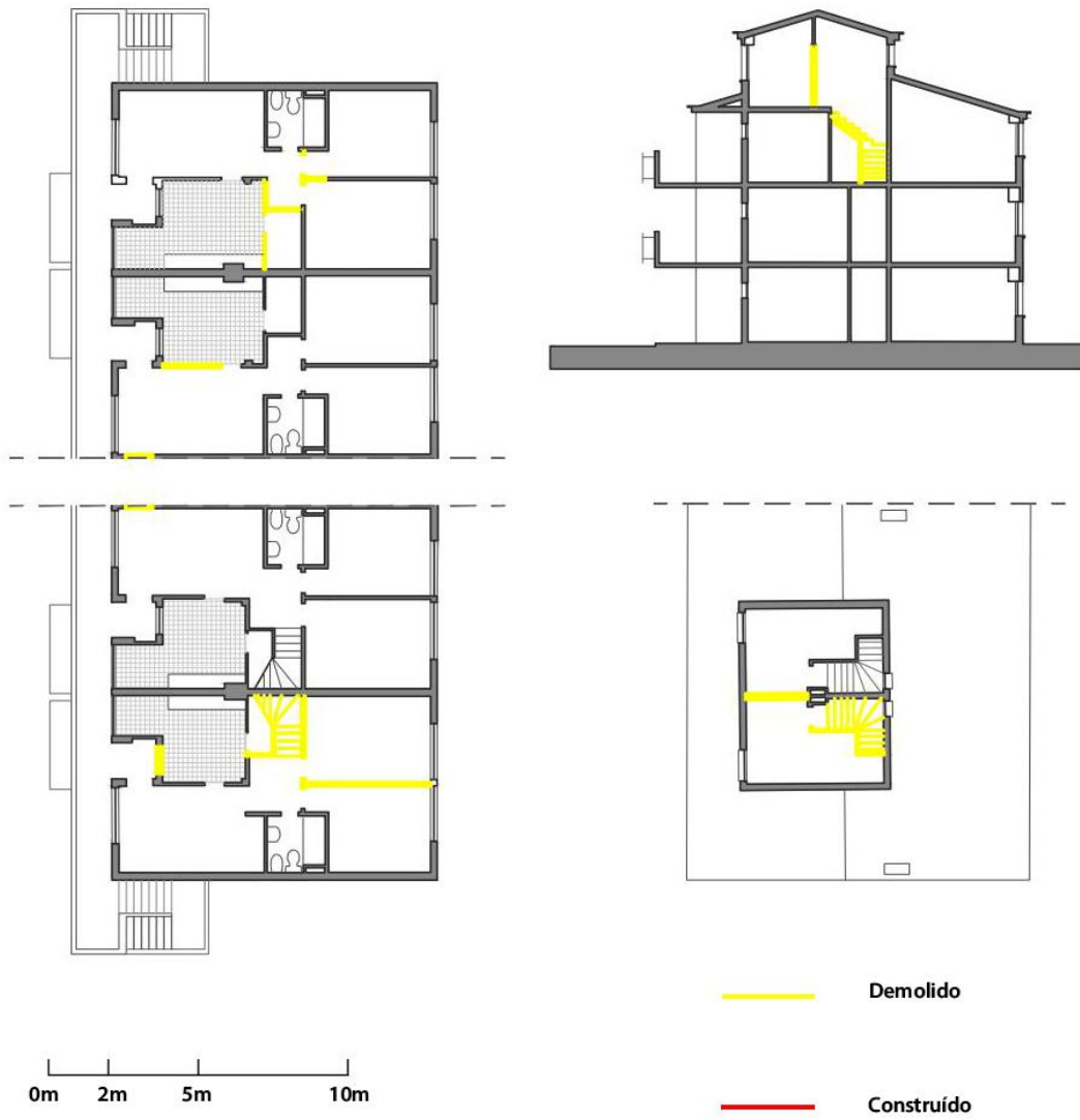
Figura 23 – Representação exemplos dos elementos demolidos ou alterados da proposta inicial, produzido pelo autor.
