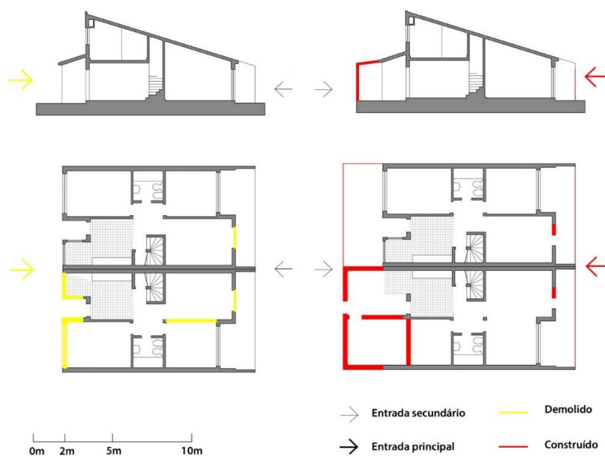
Figura 22 – Representação exemplos dos elementos demolidos ou alterados da proposta inicial, produzido pelo autor
