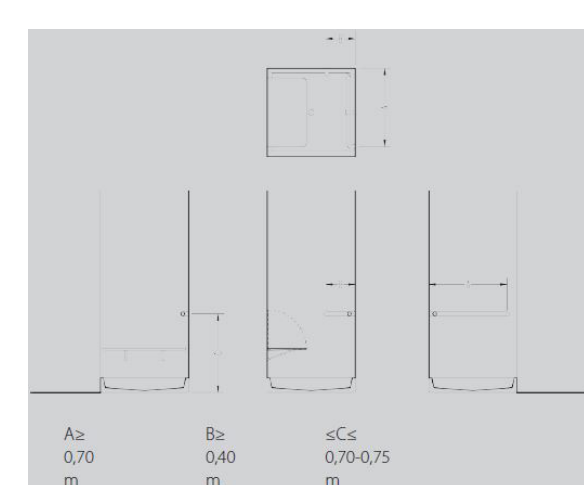
Barras de apoio instaladas junto à base de duche.
