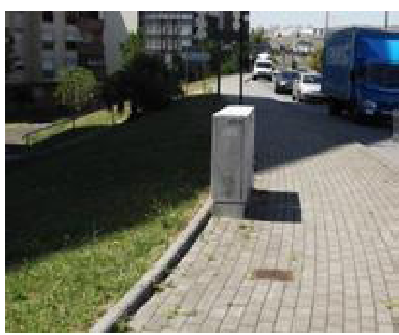
Estes armários devm ser removidos e/ou realocados dos locais onde não é respeitada a largura livre do passeio (1,20m) e ajusta-os à sua nova localização.
