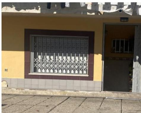
**Figura 102** Entrada do apartamento inacessível para uma pessoa com mobilidade reduzida
