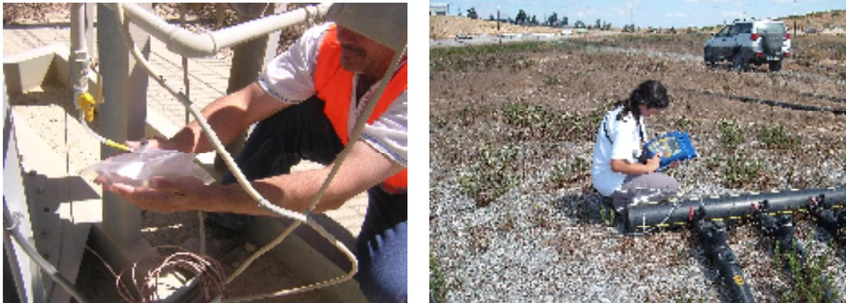
**Figura 3.7. Recolha de uma amostra de biogás e análise das características físico químicas (Fonte: Valorsul, 2010)**
