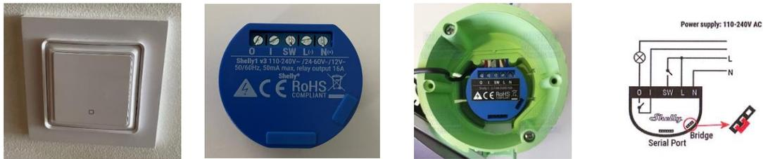
Figura 27 - Relé de controlo de iluminação
