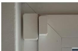
Figura 18 - Sensor de contacto Sonoff
