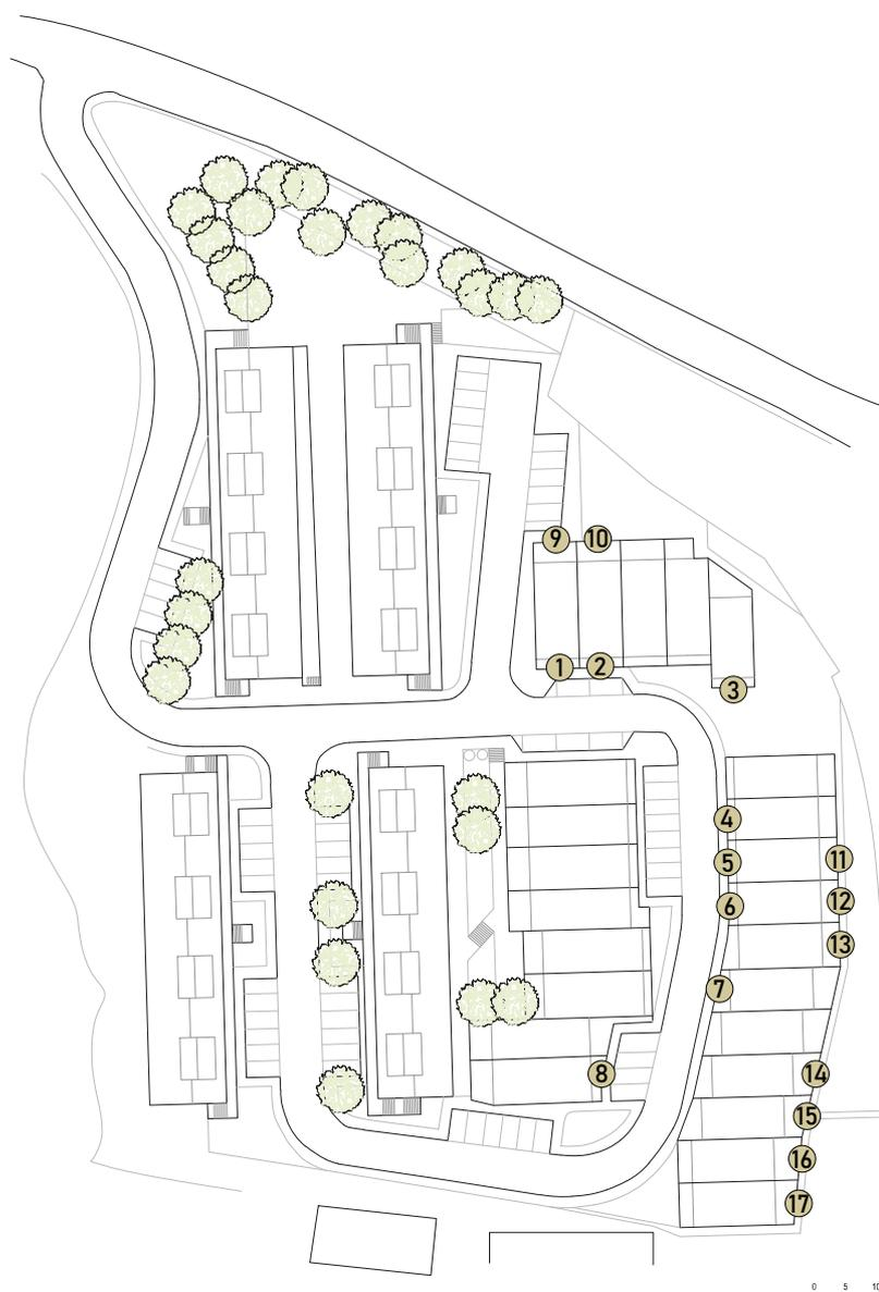
Figura 36 - Planta com registo das alterações dos muros nas moradias da Parcela 6
