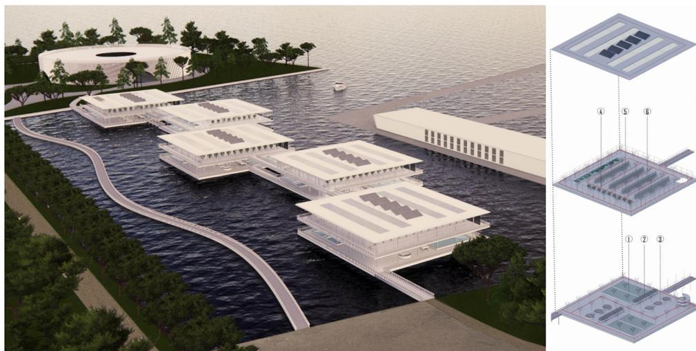
Fig. 47 e 48 Imagem 3 D e Axonometria das estruturas modulares flutuantes. Imagem elaborada pelo grupo no âmbito de PFA, 2022.
