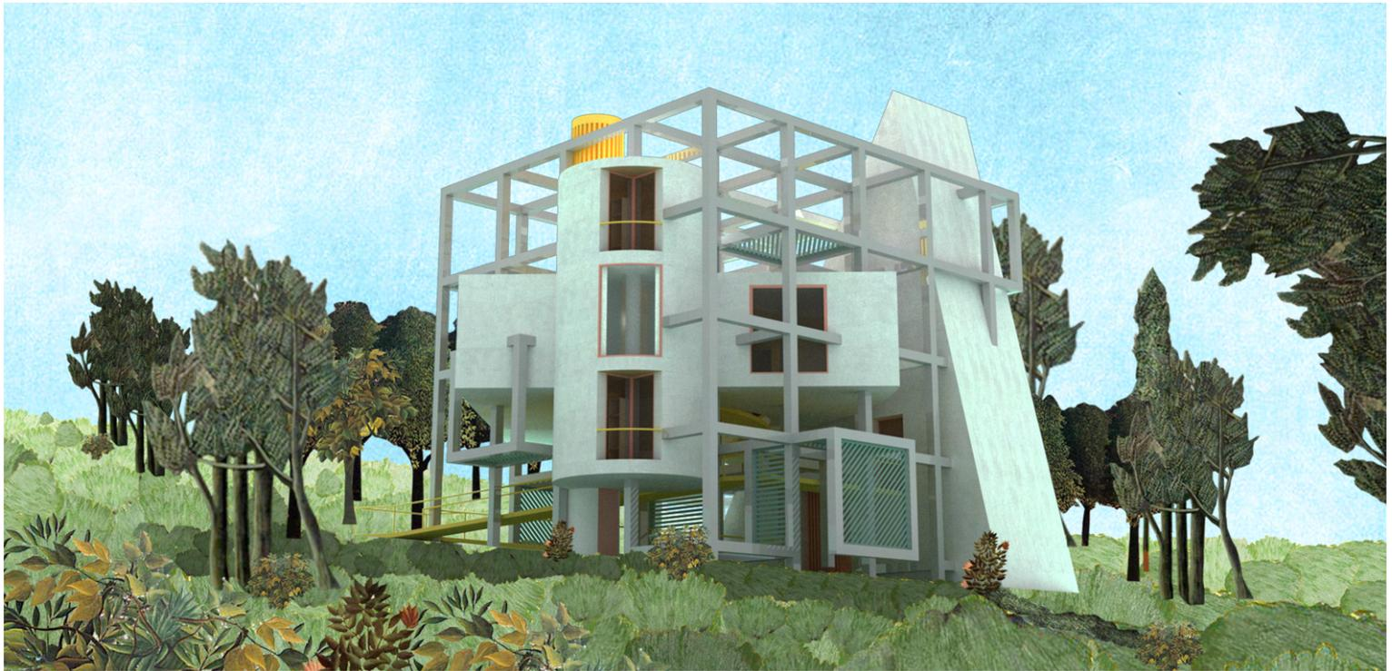
O cilindro vertical representa um momento de tensão no projeto. Um elemento menor como a coluna de escadas adossada ao cilindro apoia-se no terreno enquanto o volume maior permanece em suspensão agarrado ao volume em quarto de círculo. Entre a base do cilindro e o terreno sobram apenas 2.30m, o que comprime a passagem para o contraste do interior amplo da estrutura, atravessado por pilares, vigas e rampas.
