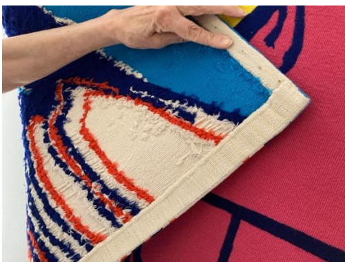
Figura 12 — Os fios de lã que sobram do avesso onde são feitos os nós, são cortados no final, “tosquiados” como referem as tecedeiras, e onde não se vêem os excertos de lã “tosquiados”, acontece, pela sequência do ponto, e assim resulta o verso da tapeçaria, como se observa na figura. Fotografia de uma Tapeçaria do pintor António Charrua patente na sala dos teares da manufatura. Fotografia : Telmo Lopes.
