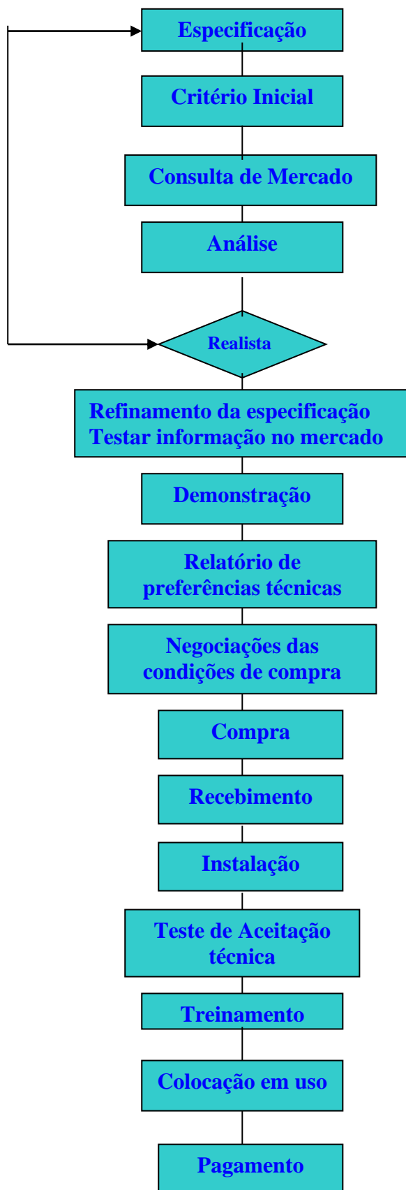
Fluxograma 1 - FLUXOGRAMA DA AQUISIÇÃO DE EQUIPAMENTOS BIOMÉDICOS (Pode ser utilizado por Instituições Públicas e Privadas)
