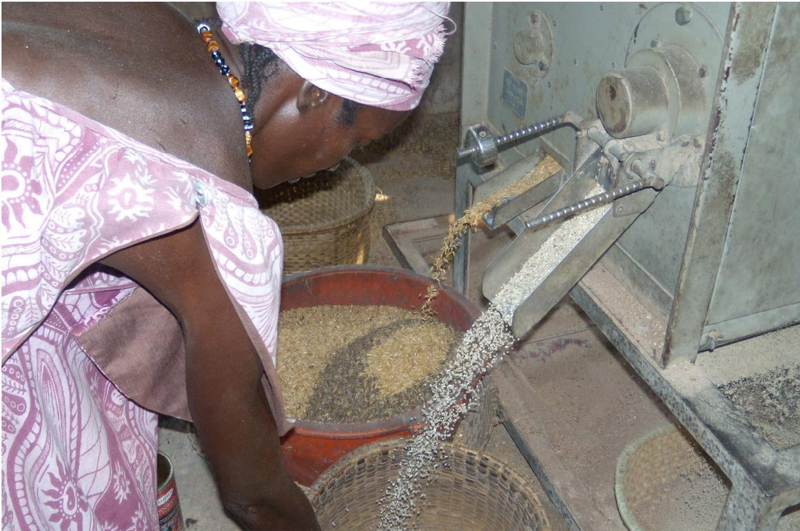
Figura 3.6. Mulher recolhendo o arroz descascado pela máquina descascadora. (Fonte: Fotografia tirada no decorrer do trabalho de campo.)
