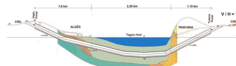
FIGURA 56 - CORTE LONGITUDINAL TÚNEL ALGÉS-TRAFARIA
