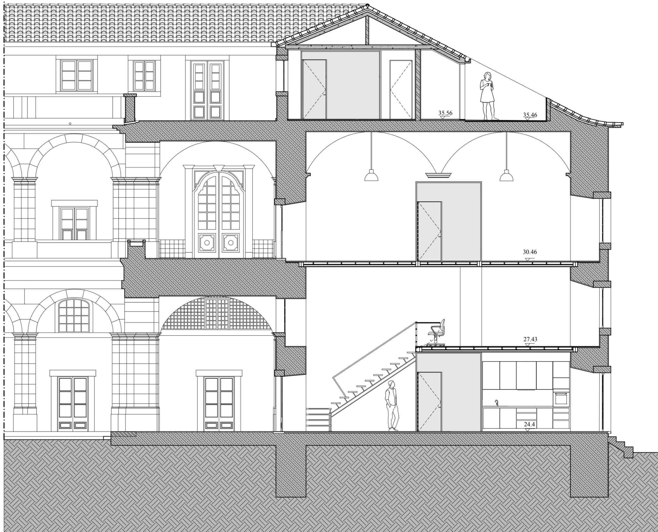
Fig. 63 - Célula de habitação proposta Corte A-A'
