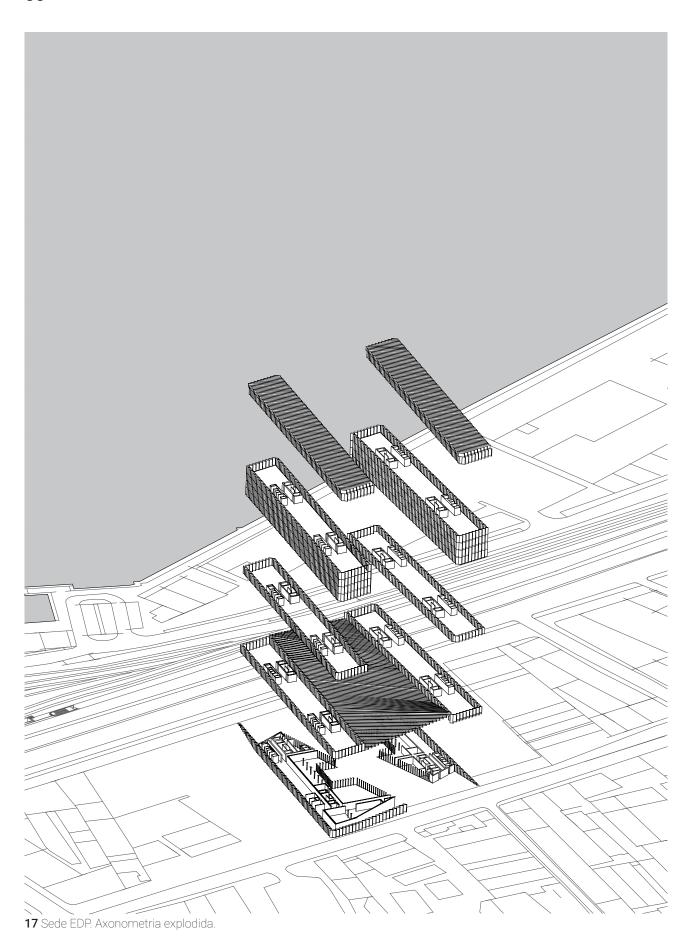
O sistema estrutural encontra-se dividido entre uma base em betão armado que se situa abaixo da linha de terra e uma gaiola em estrutura metálica, na qual se integram as lâminas referidas, que ergue todo o edificado construído acima do solo (Tavares, 2015).
