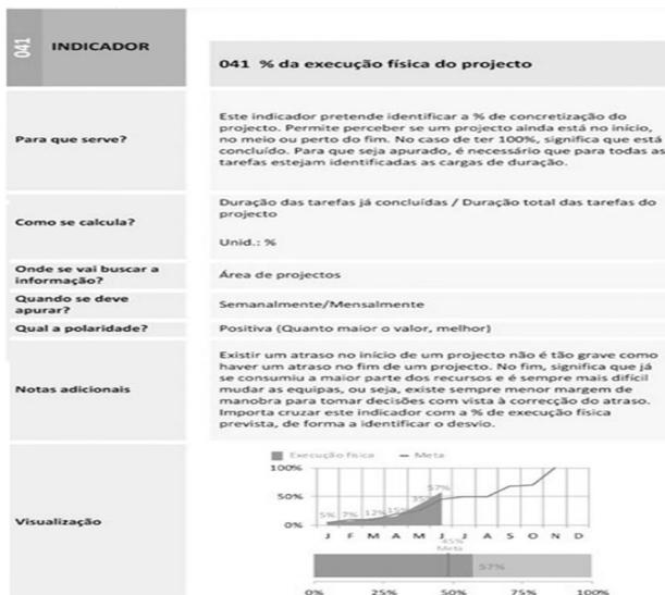
Figura 1 – Exemplo demonstrativo de um indicador usando o modelo 1.
