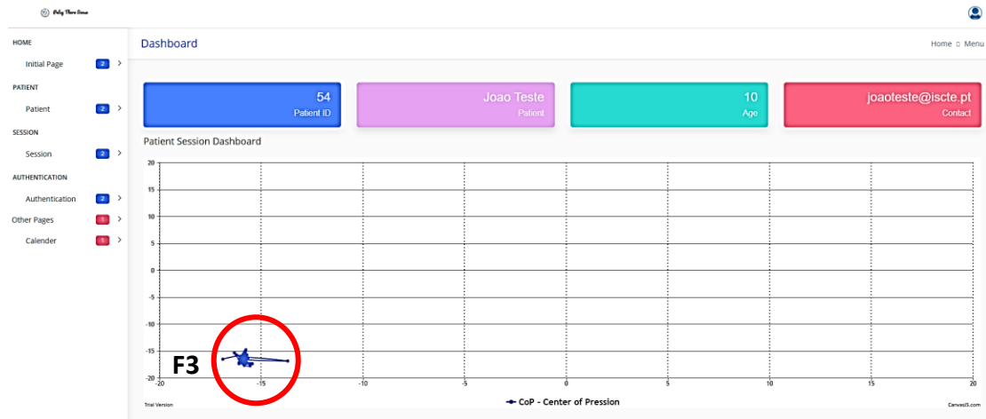
Figura 59 - Carga estática de cerca de 50kg, sobre o sensor F3. O ponto mais à direita indica quando a carga deixa a plataforma.
