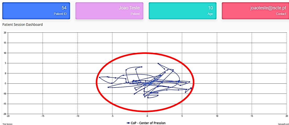
Figura 66 - Carga estática e em equilíbrio sobre centro da plataforma.
