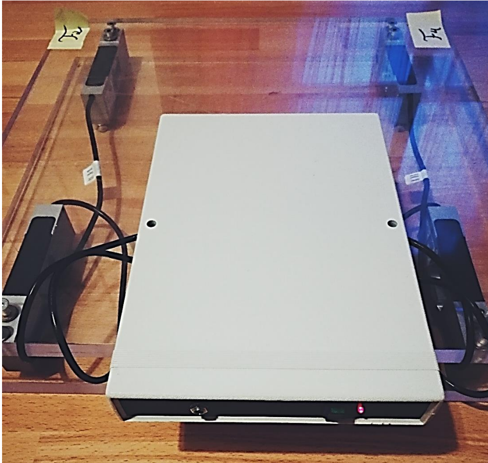
Figura 22 - Vista de cima da plataforma, com o compartimento dos circuitos eletrônicos fechado e sobre a superfície da plataforma
