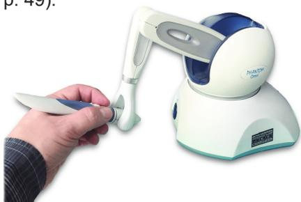
Figura 18 – Dispositivo háptico “PHANTOM Omni”<sup>5</sup>
