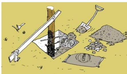
**Fig. 5.6: Fundação em poste de madeira**
