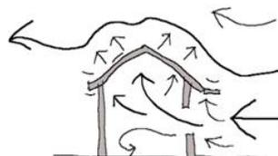
**Fig. 5.10: Pressão do vento sobre uma estrutura com apenas um vão**
