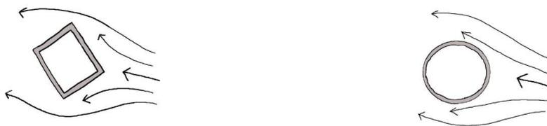
**Fig. 5.5: Formas de construção que melhor respondem ao fluxo do ar**
