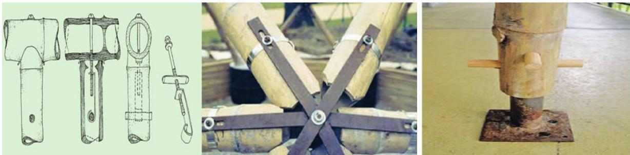
**Fig. 4.8: Exemplo de técnicas de conexão convencionais**
