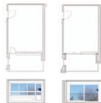
**Ilustração 29 – Vista exterior dos edifícios mais baixos reabilitados e esquema da reabilitação da sala de estar/varanda**
