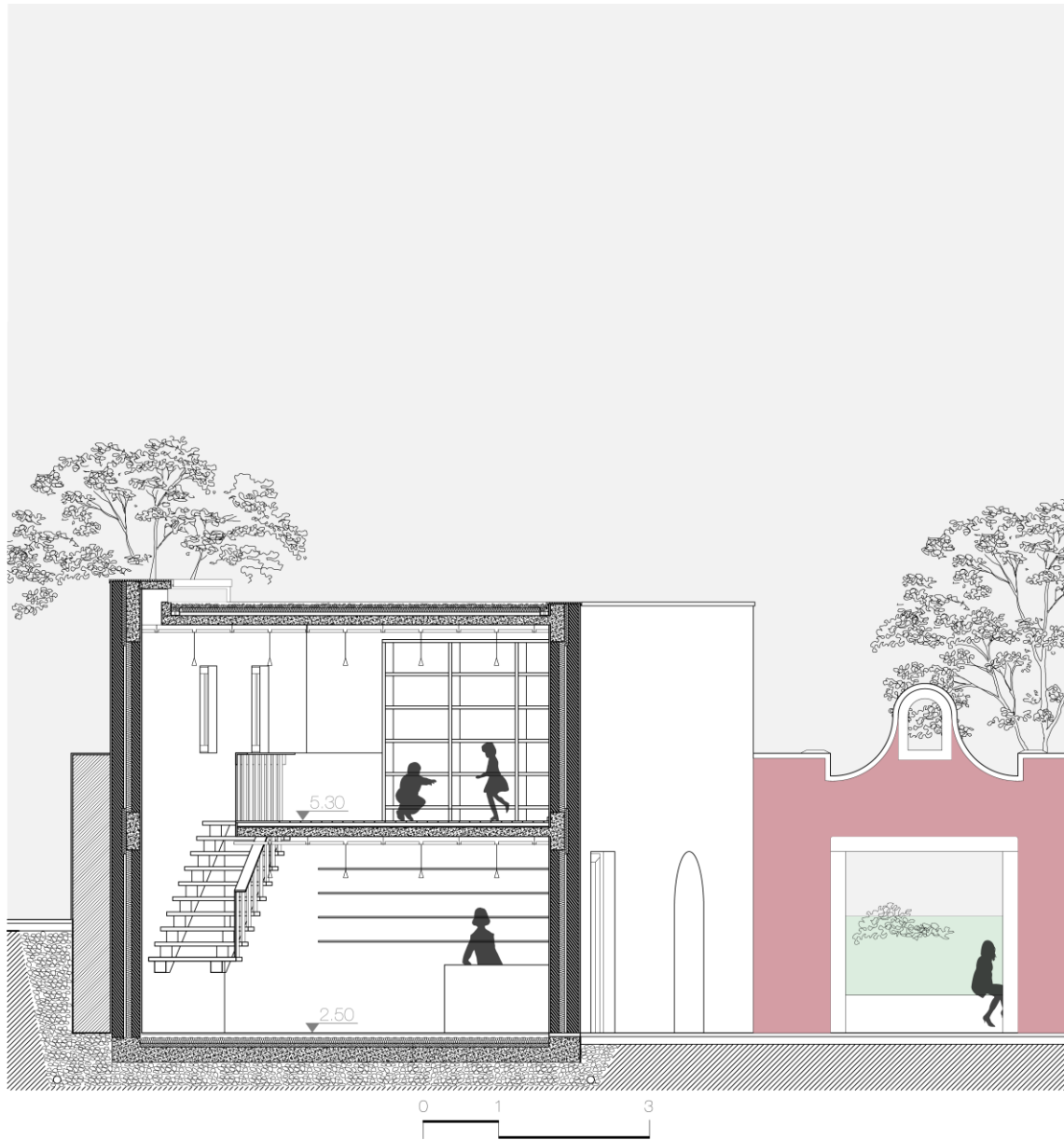
Figura 86 – Corte construtivo EE' pelo Serviço Educativo
