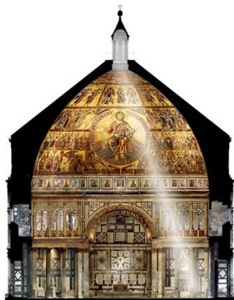
Figura 3.26- Sezione trasversale: restituzione vettoriale integrata da ortoimmagine ad alta risoluzione, 2013-2014, BONORA, Valentina et. al. (imagem editada pela autora). Fonte: Architettonico - GECO
