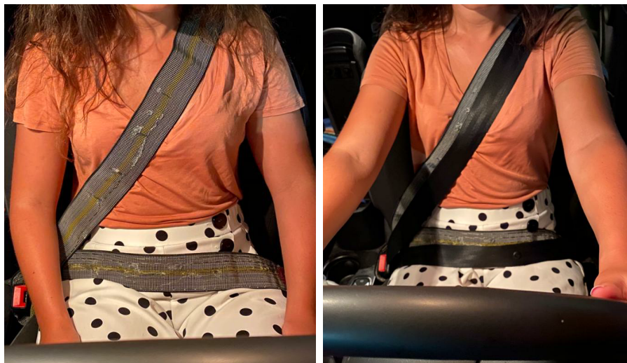
FIGURA 4.9: Protótipo de Cinto de Segurança Háptico - Utilização
