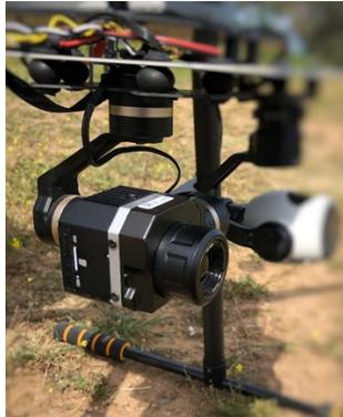
Fig. 4. Thermal Camera - FLIR Vue Pro
