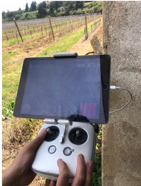
FIGURA A.6. Mecanismo de controlo do drone composto por um *tablet* e um comando
