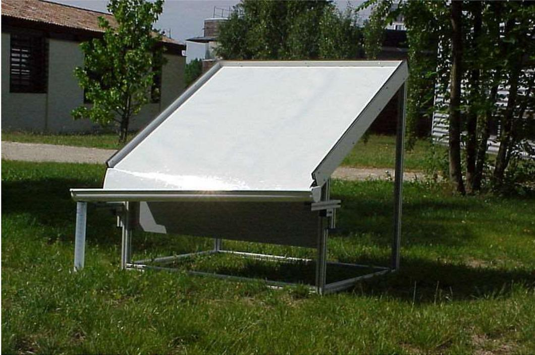
Figura 28 Exemplo de um condensador de orvalho (OPUR, s.d.)
