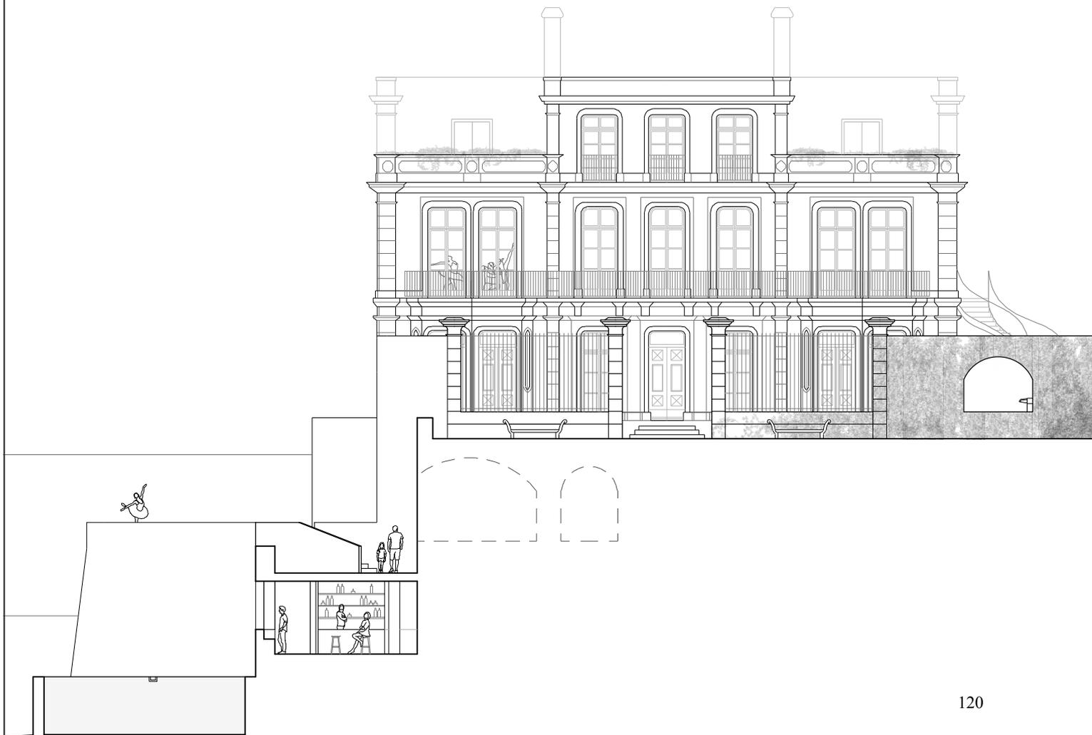
A fachada que confronta a rua a sul segue a cota do muro pré-existente que define o pátio de honra, tendo recuado uma diferença de cota que secundariza o volume criado e que no interior do edifício resulta numa definição e separação entre uma zona de circulação, com um pé direito mais reduzido, e a sala de estudo com um pé direito mais elevado relacionando-se com o jardim de buxo.
