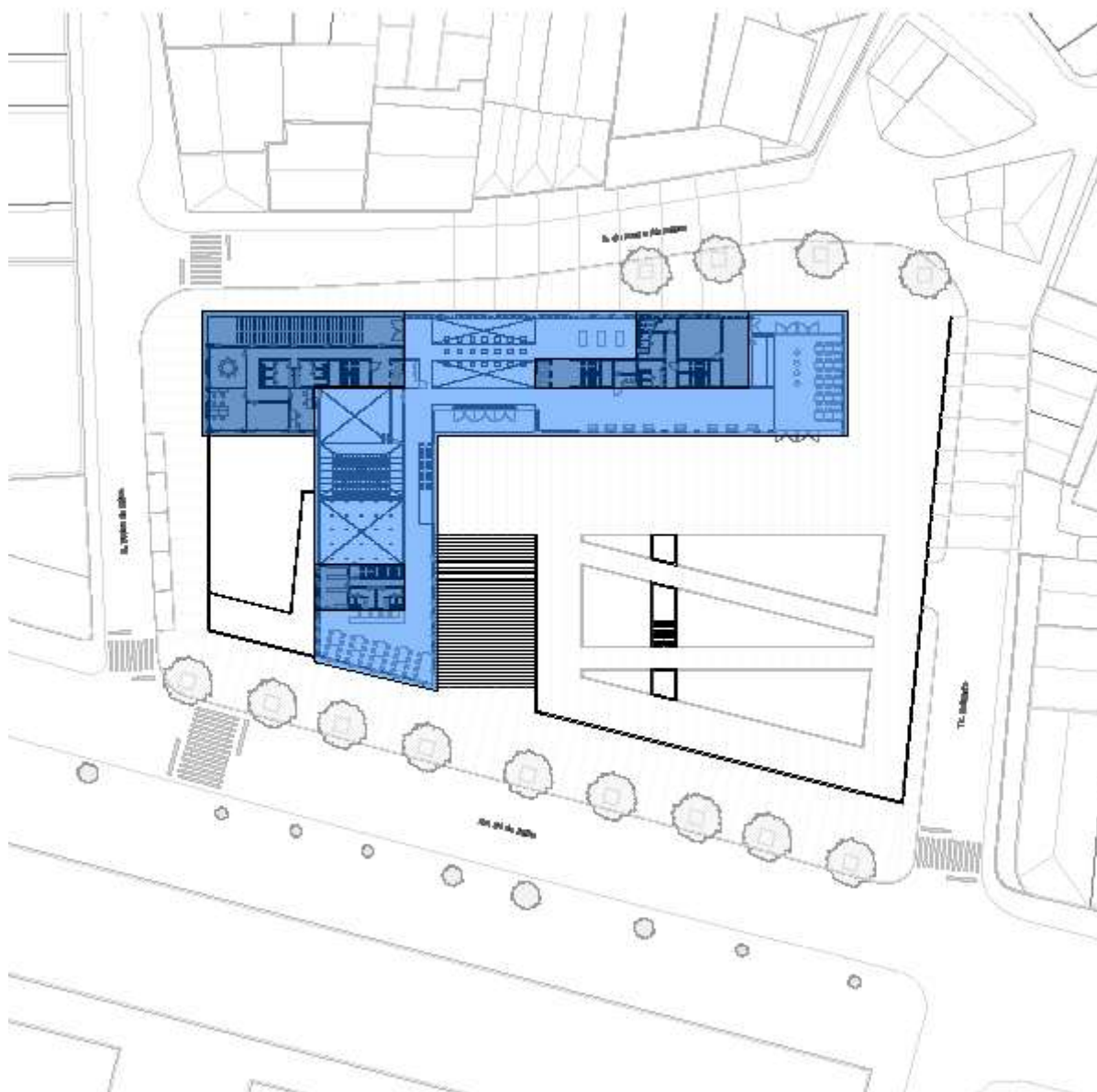
Figura 35 - Planta do 1º Piso, marcando as áreas públicas e as áreas de serviço, reduzido da escala 1:125 (Fonte: Autor)
