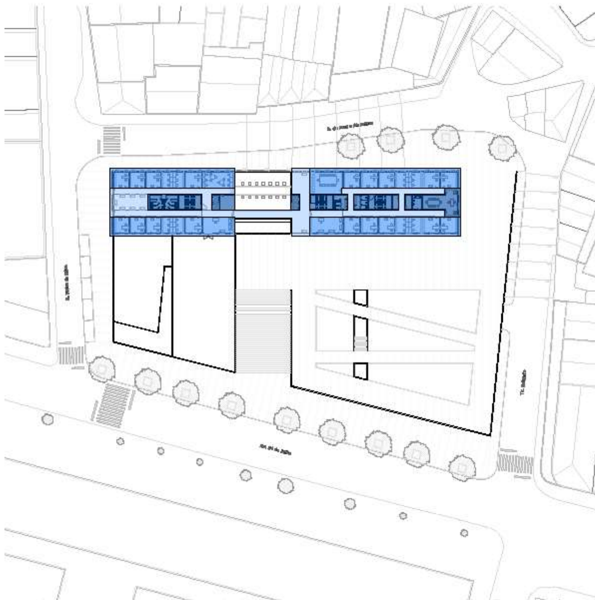
Figura 49 - Planta do 3º piso, marcando a circulação, os espaços de escritório e os módulos de serviço (Fonte: Autor)
