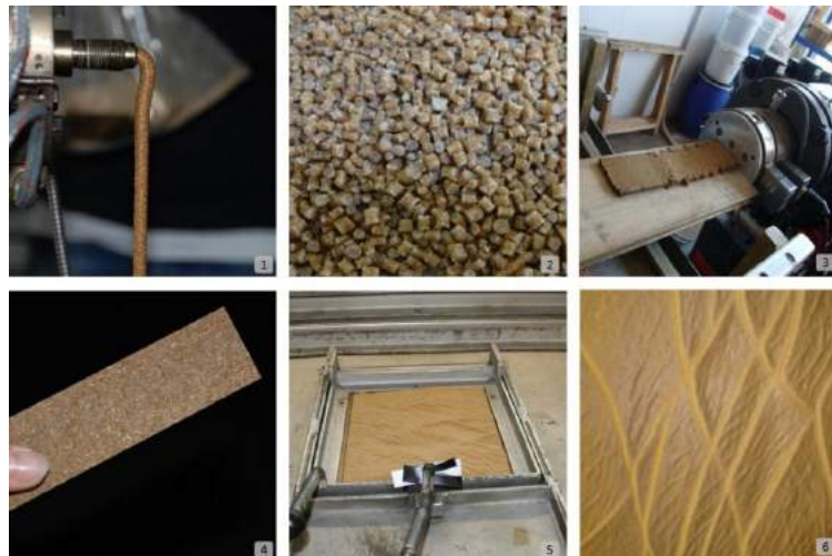
Figura 283 lustração dos seis necessários processos de fabricação Plant Culture
