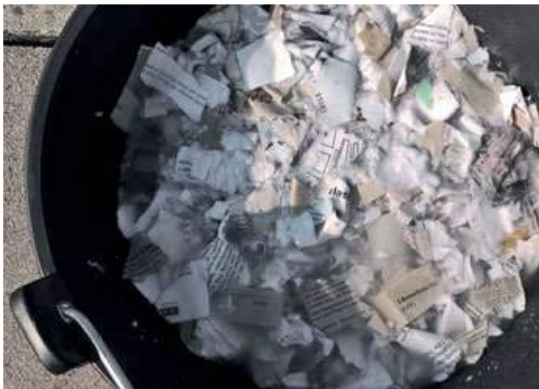
Figura 193 No processo de produção, o papel picado é adicionando água para dissolvê-lo. (Hebel, Wisniewska, & Heisel, 2014)
