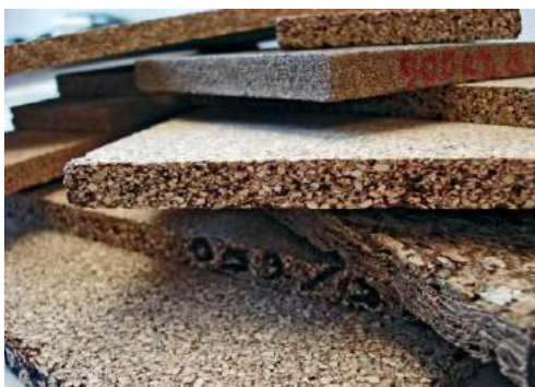
Figura 289 Painéis de isolamento com resíduos agrícolas. (Hebel, Wisniewska, & Heisel, 2014)
