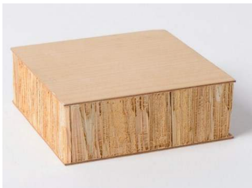
Figura 304 Exemplo Painéis de construção leve feitos de uma estrutura esponjosa à base de Typha (Peters, 2012)
