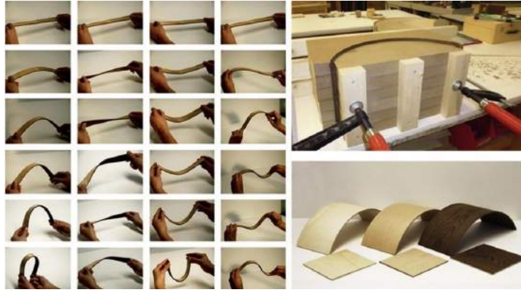
Figura 282 Ilustração da flexibilidade do painel Bio-flexi quando folheado de um lado e como ele pode ser folheado de ambos os lados
