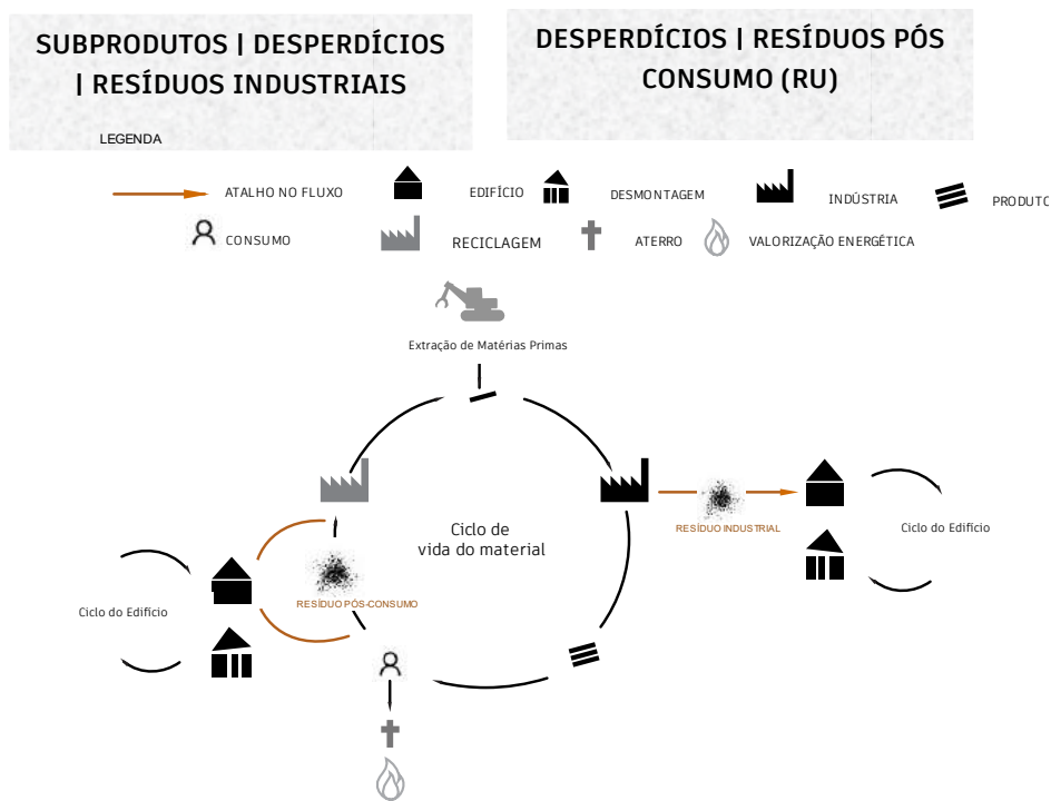
Figura 116 Representação gráfica de um corte temporário no fluxo normal de um determinado resíduo para ser aplicado como material de construção.
