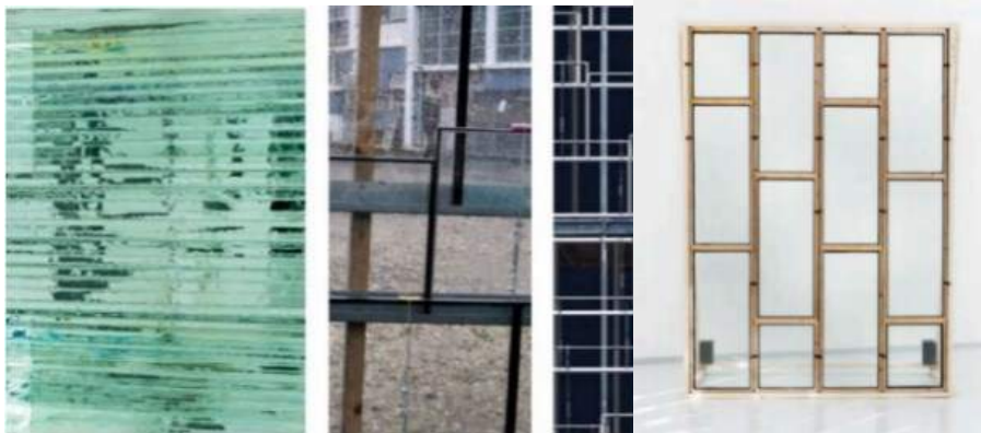
Figura 104 Protótipos construídos a partir de resíduos de vidro e janelas usadas (Vandkunsten Architects, 2016)
