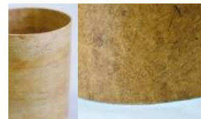
Figura 275 Biocompósito feito com adesivo de soja (Peters, 2012).
