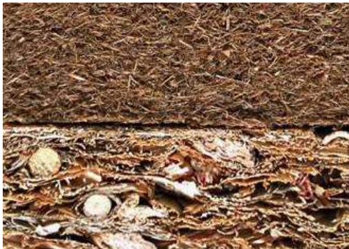
Figura 286 Os resíduos agrícolas são compactados (Hebel, Wisniewska, & Heisel, 2014)
