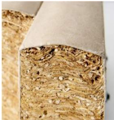
Figura 108 Os resíduos de palha compactados. (Hebel, Wisniewska, & Heisel, 2014)
