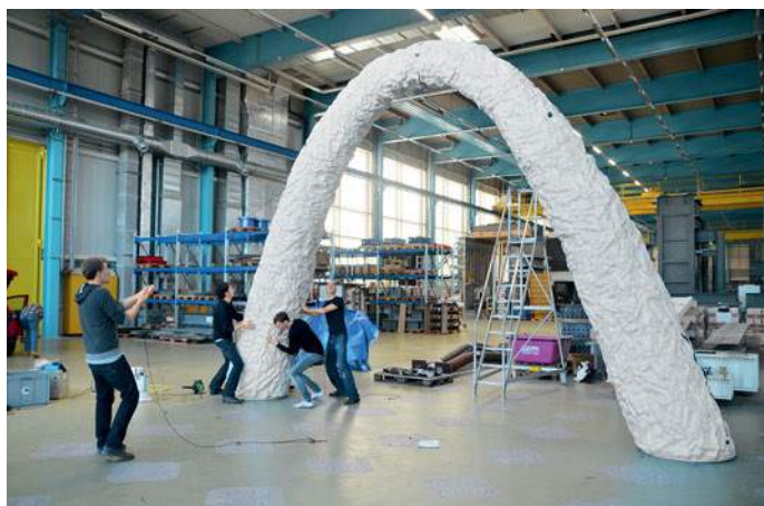
Figura 120 Pormenor construtivo e Arco depois de aspirado. As garrafas comprimidas criam um sistema estrutural robusto (Hebel, Wisniewska, & Heisel, 2014)
