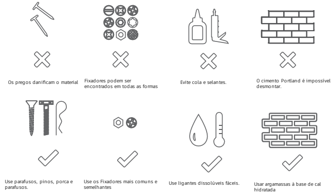
Figura 62 Estratégias a que ao consideram o design para desmontagem. (Danish Environmental Protection Agency, 2019)
