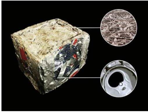
Figura 299 O bloco de construção Mycoform é feito dos micélios de cogumelos envoltos em folhas de alumínio recicladas (Terreform).
