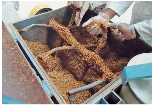
Figura 288 Um misturador de baixa tecnologia mistura o lixo agrícola com o aglutinante de tanino (Hebel, Wisniewska, & Heisel, 2014)
