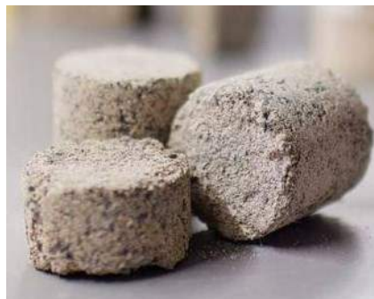
Figura 112 Bio tijolo feito a partir de urina humana (Swingler, 2018)
