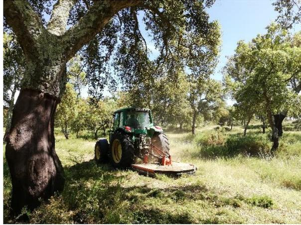
Figura 19: Controle da vegetação espontânea através do uso de corta-mato.
