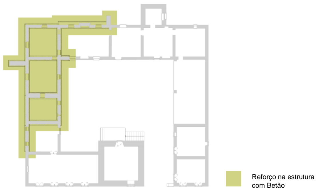
Figura 36: Estrutura em alvenaria de pedra reforçada por betão
